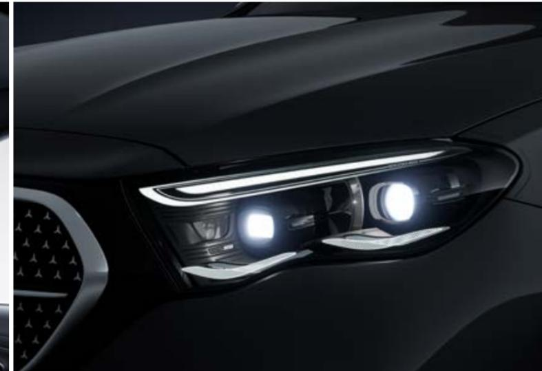
DIGITAL LIGHT mit Projektionsfunktion (PAX) und Adaptiver Fernlicht-Assistent Plus (628)<sup>1</sup>
