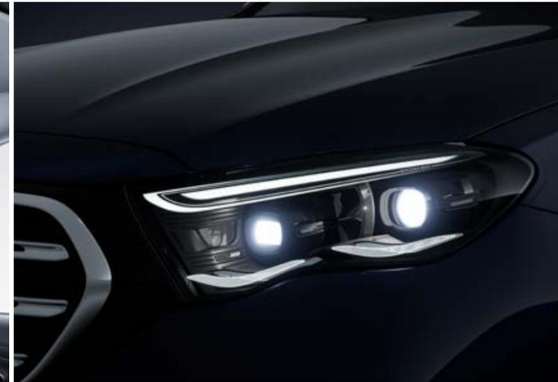
DIGITAL LIGHT mit Projektionsfunktion (PAX) und Adaptivem Fernlicht-Assistent Plus (628)<sup>1</sup>
