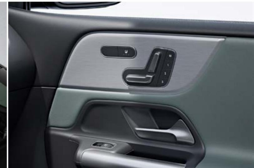
Vordersitz rechts elektrisch verstellbar mit Memory-Funktion (242) und Fahrersitz elektrisch einstellbar mit Memory-Funktion (275)
